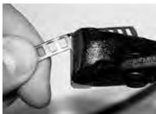
Krok 3 Odcąć nadmiar taśmy. Aby uniknąć obrażeń w czasie montażu, spiłować krawędź pilnikiem.
