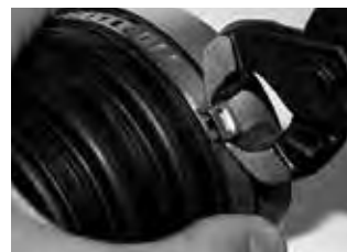
Krok 4 Umieścić opaskę na łączonym elemencie. Zaczepić haczyki zamka w okienku zapewniającym najciaśniejsze położenie. Dokładnie zacisnąć ucho za pomocą zaciskarki Oetiker.
