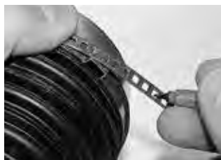
Krok 2 Ustalić długość opaski. Należy upewnić się, że koniec opaski przechodzi przez „ucho” jak pokazano na rysunku.
